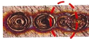
(IR) PULSEレーザーによる銅板への溶接痕
